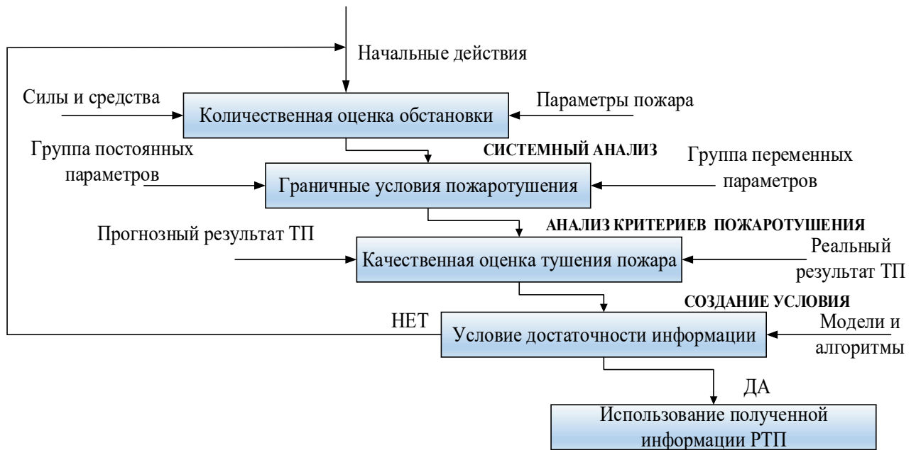
Рисунок 1.8 – Схема качественной оценки тушения пожаров в ПС в граничных условиях пожаротушения
